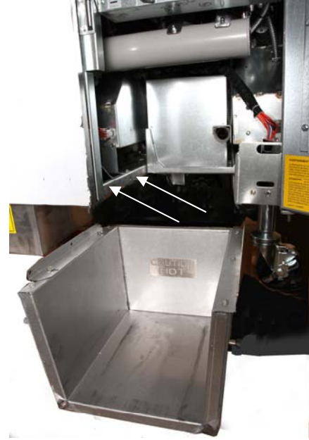
Şekil 1: Görevi kabine eritme ünitesi ve dolap içine verilen vidalar ile eklemek
